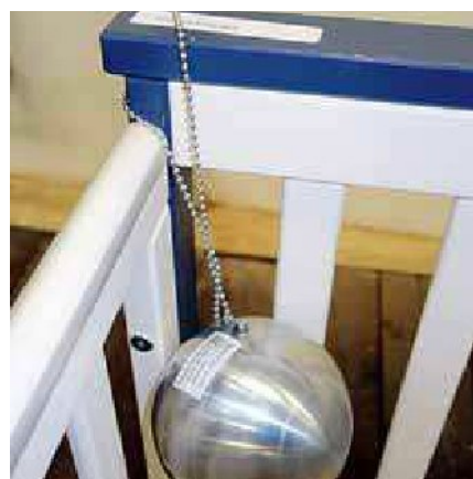
4. U postýlky Rene hrozí uškrcení dítěte, pokud se částí oděvu zachytí za vyčnívající zakončení čel jako řetěz s koulí ve zkušebně.
