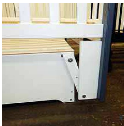
3. Detail nebezpečného střihového místa na houpacím mechanismu postýlky Rene.
